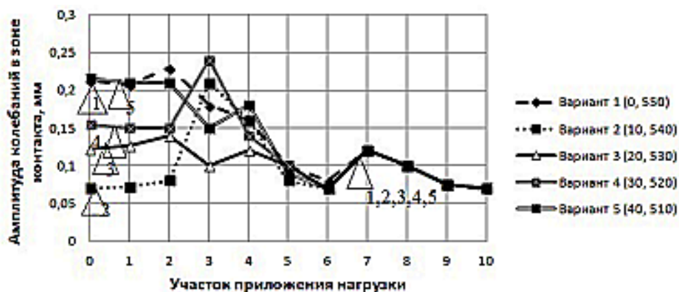
Рис. 5. Изменение амплитуды колебаний в зоне контакта круга и заготовки вдоль оси заготовки для условий в табл. 2
